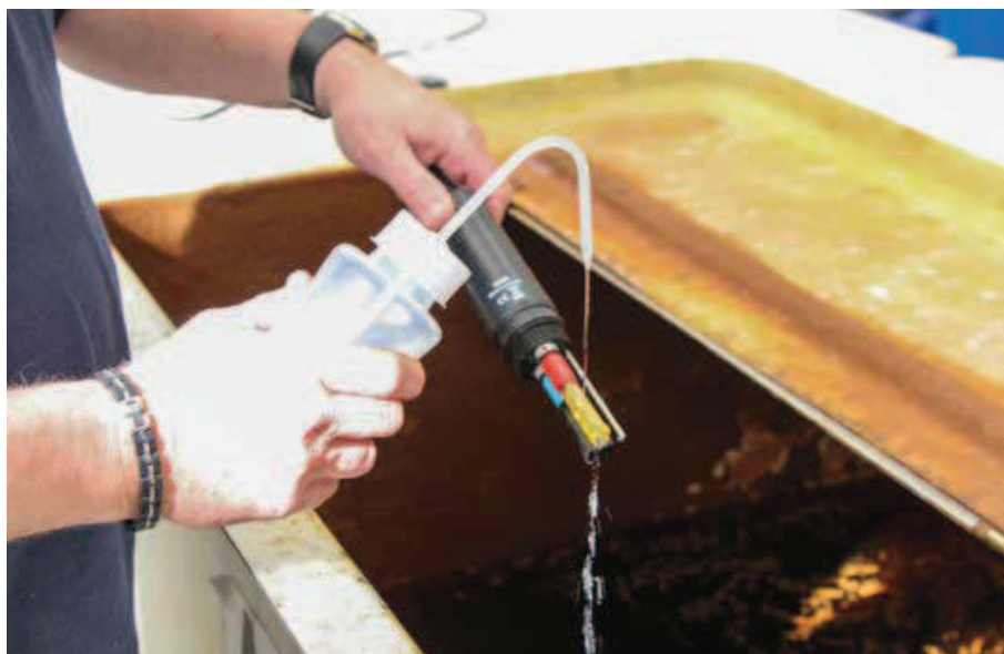
Ook tussen metingen door moeten de elektroden van pH-meters goed worden schoongespoeld. Gebruik daarvoor altijd demiwater.
